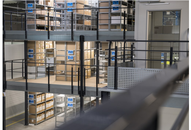
Mehrgeschossanlage: Nachschub und Kommissionierung auf getrennten Ebenen.
